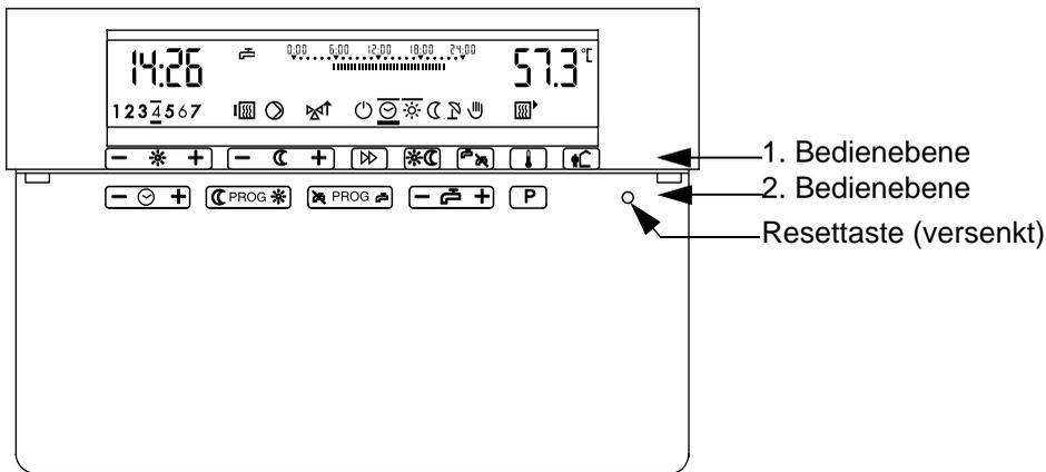
Diese Ansicht zeigt das Gerät mit geöffneter Abdeckung
