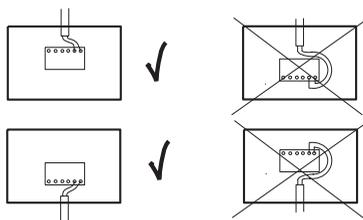
Verbindungsleitungen vom Datenbus etc. sind getrennt von Starkstromleitungen zu installieren.
