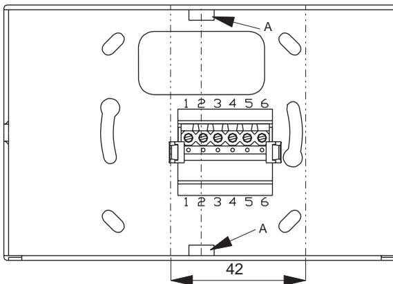
Die Kabel sind durch die Öffnung im Boden oder die ausbrechbaren Einführungen A in der Mitte oben bzw. unten in den Kabelraum zu führen.
