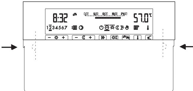
Die Fernbedienung ist mit einem Anschluss- und Montagesockel ausgerüstet. Um die Fernbedienung abzuziehen sind die seitlichen, verdeckt unter der Frontblende angeordneten Nocken mit den Fingern einzudrücken.
