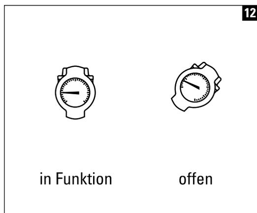
Die Solarstation ist in Vor- und Rücklaufstrang mit je einer Schwerkraftbremse ausgestattet. Im Vorlaufstrang ist diese im Thermohahn integriert und bei Bedarf kann die Schwerkraftwirkung aufgehoben werden. Bei Normalstellung des Thermohahns (senkrechte Stellung der roten Armatur) ist die Schwerkraftbremse in Funktion, bei 45°-Stellung ist der Vorlauf in beide Fließrichtungen offen. Im Rücklauf funktioniert der Schwebekörper des Flowmeters als Schwerkraftbremse.
