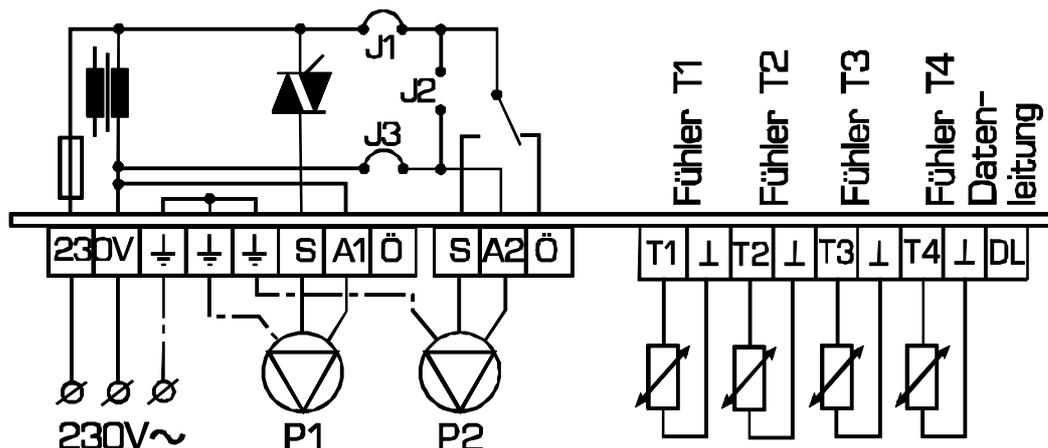
**Hinweis:** Als Schutz vor Blitzschäden muß die Anlage den Vorschriften entsprechend geerdet sein. Fühlerausfälle durch Gewitter bzw. durch elektrostatische Ladung sind meistens auf fehlende Erdung bzw. fehlenden Überspannungsschutz am Kollektorfühler zurückzuführen.
