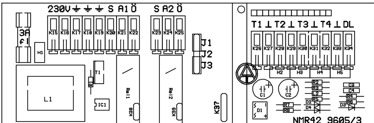
Mit der Stiftleiste K37 ist die Nachrüstung eines zusätzlichen (potentialfreien) Relais möglich, welches beliebig mit den beiden Ausgängen verknüpft werden kann.
