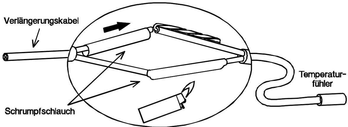
Den beigelegten Schumpfschlauch auf 4 cm halbiert über eine Ader schieben, die blanken Drahtenden fest verdrillen, dann den Schumpfschlauch über die blanke Stelle schieben und vorsichtig erwärmen (zB. mit einem Feuerzeug), bis sich dieser eng an die Verbindung angelegt hat. Diese Verbindung kann dann bequem in die Verrohrung eingezogen werden.
