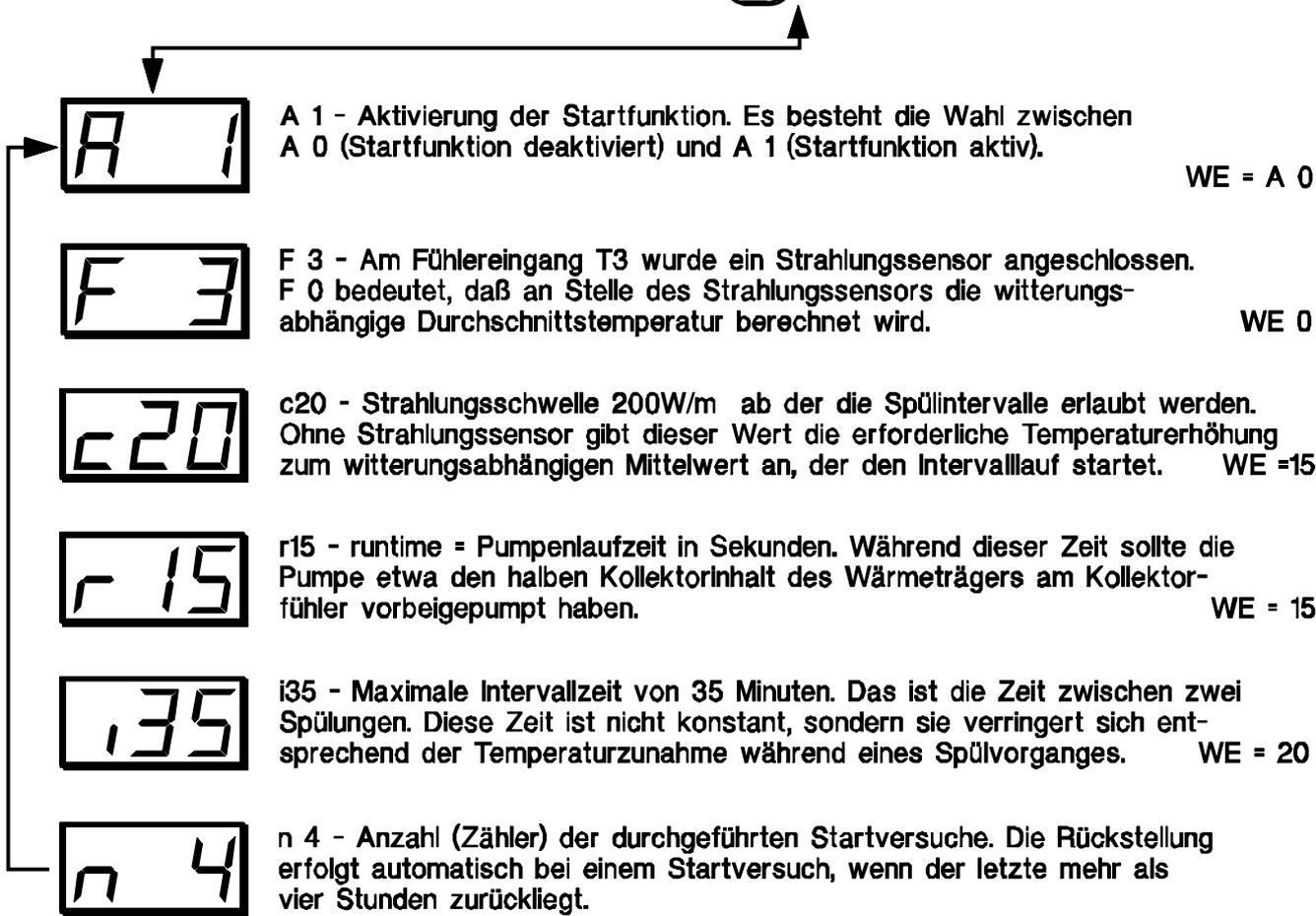
Die Startfunktion ist werksseitig deaktiviert und wird nur in Verbindung mit Solaranlagen (also mit dem Schema 0) eingeblendet.
