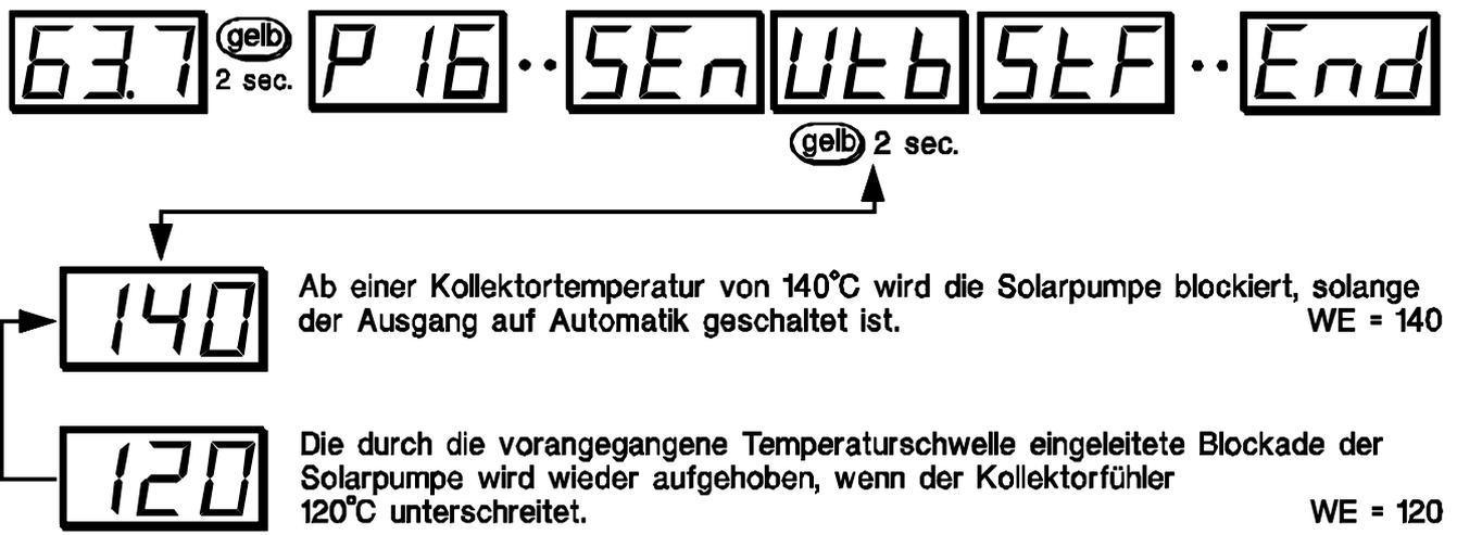
Die höhere Temperatur ist jene, durch die abgeschaltet wird.
